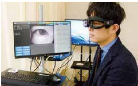
y-VOG／高齢者を中心に増えている良性発作性頭位めまいやメニエール病など「めまい」の検査に使う眼振計測システム。電極を張り付ける必要のある電気眼振図（ENG）に代わり、カメラ付きゴーグルにより眼球の動きを数値化してめまいの治療をする
