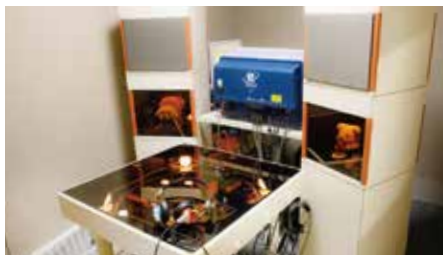
聴覚検査装置・乳幼児聴力検査装置／一般的な聴覚検査装置に加えて赤ちゃんや子どもが遊戯を通じて音への反応を確認できる検査。補聴器調整では専用の補聴器適合検査装置で的確に聴力の改善をめざす
